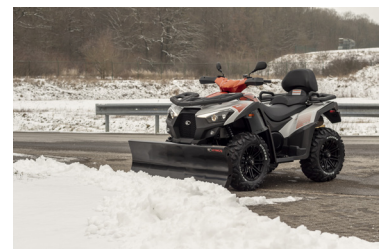
LAME A NEIGE ET AGRICOLE 1400 mm + SUPPORT Pour MXU 500 / 550 / 700 KA-01-0380
